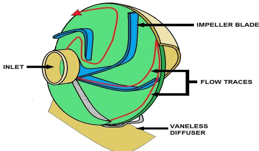
COMMON PUMP IMPELLER
