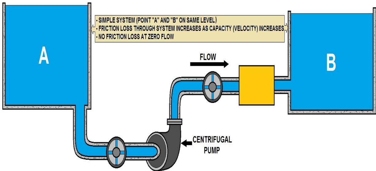
**CENTRIFUGAL PUMP CURVE CHARACTERISTICS**
