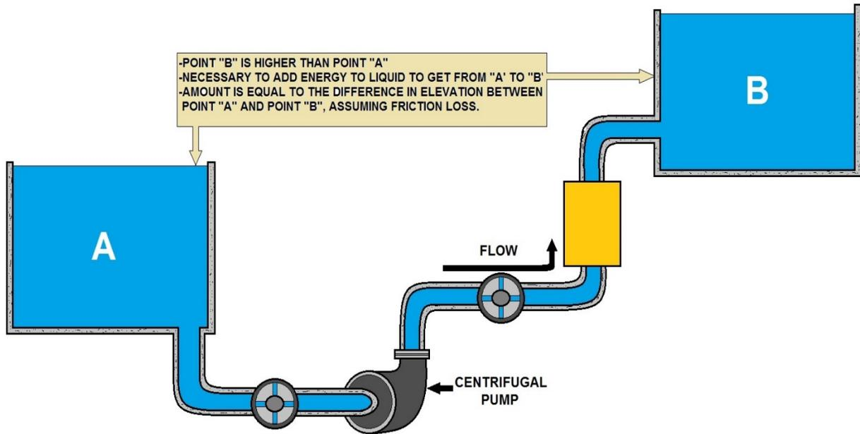
**CENTRIFUGAL PUMP CURVE CHARACTERISTICS**
